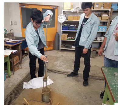
土木実験 (土の締め固め)
