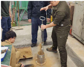
土の締固め試験
