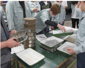
骨材のふるい分け試験
