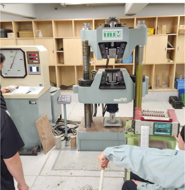
コンクリート強度試験
