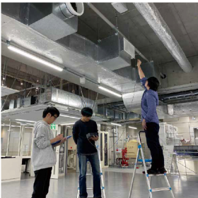
建築環境測定（風速測定）
