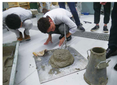
建築材料実験
