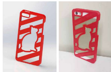
ものづくり実習 スマートフォンケースの作成 (左)3Dデータ (右)3Dプリンター造形物
