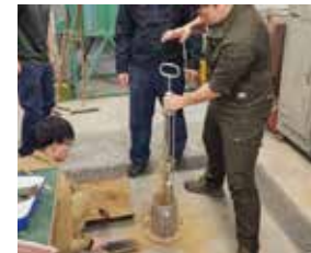
土の締め固め試験
