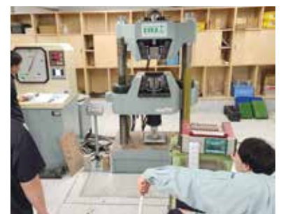
コンクリート強度試験
