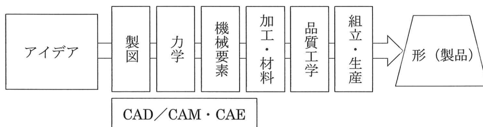
図1 機械の設計プロセス (MONOWEB から引用)
