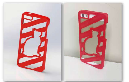
デジタル造形 スマートフォンケースの作成 (左) 3Dデータ (右) 3Dプリンタ造形物
