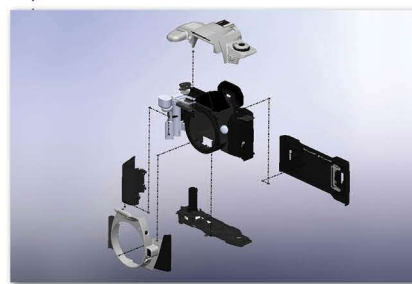
卒業制作 一眼レフカメラ拡散分解図
