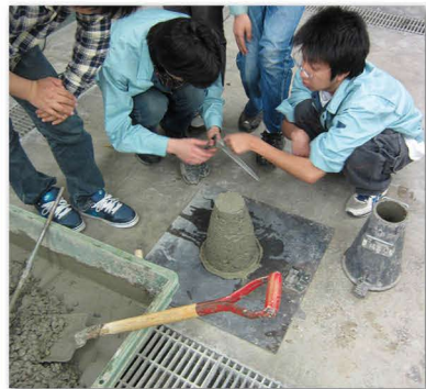
土木実験 (コンクリート)
