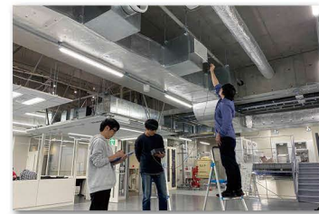
建築環境測定（風速測定）
