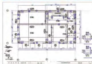
鉄筋コンクリート造躯体図
