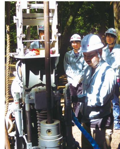
土の状態をさまざまな調査マシンを使用して調べます。サンプルを採取しながら地下の土の状態を調べる実習をします。
